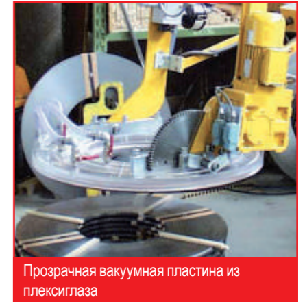
С окном в центре вакуумной пластины для облегчения позиционирования груза
