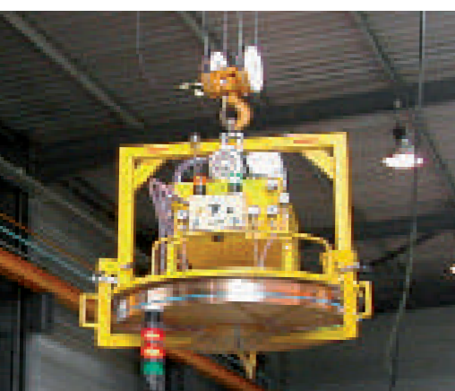
Доп. механические лапы обеспечивают «страховку» груза при его перемещении на большие расстояния
