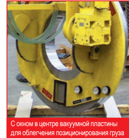
С прозрачной вакуумной пластиной выполняет загрузку рулона медной фольги
