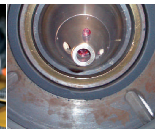
Оптический датчик для автоматической центровки на рулоне
