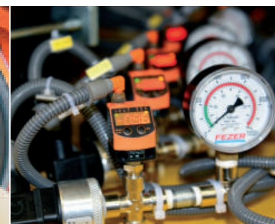
Комплект оборудования для контроля уровня вакуума в каждой из вакуумных камер
