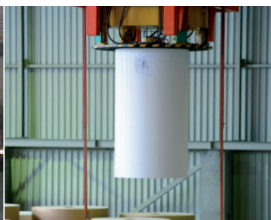
Система автоматического распознавания расположенного внизу рулона
