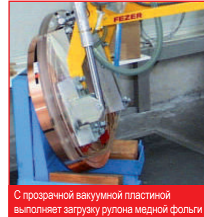
С окном в центре вакуумной пластины для облегчения позиционирования груза
